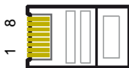
Abb.2 Kontakt- bzw. Pin-Belegung RJ45 Stecker
